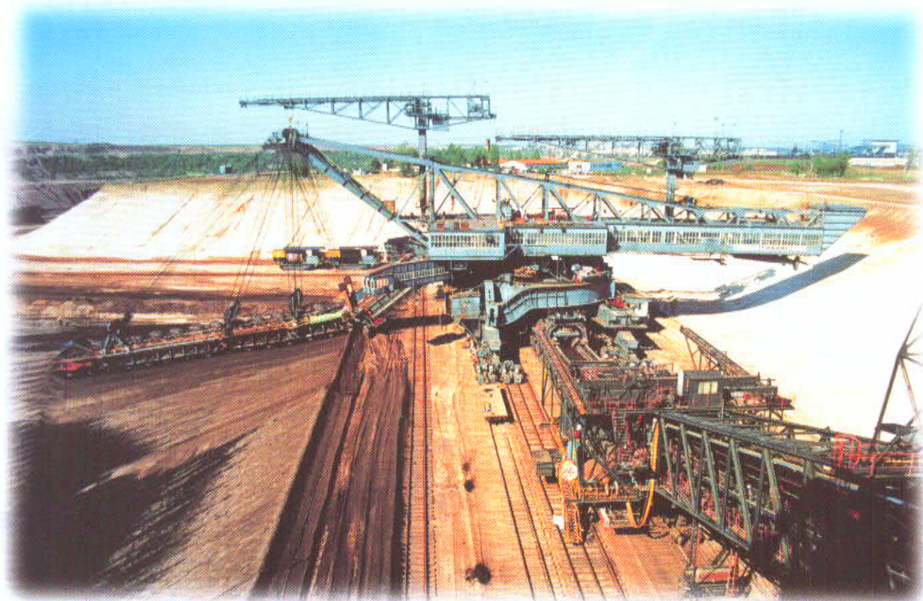
Угльное предприятие VATTENFALL/Германия, шахт Велцо-Зид, комплекс отвального моста F60 и три эскаваторы Es 3150, оснащены с 582 тормозными толкателями
