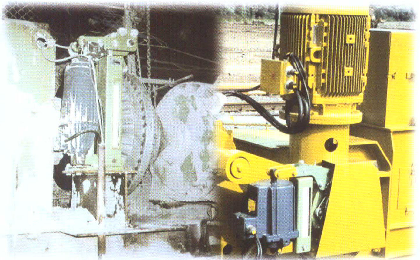
Kali und Salz AG, завод Унтербрайцбах, привод конвейера, дисковый тормоз RST2 с ELHY типа EB 1250-60 Lm2 (индикация сигнала «тормоз открыт»)
