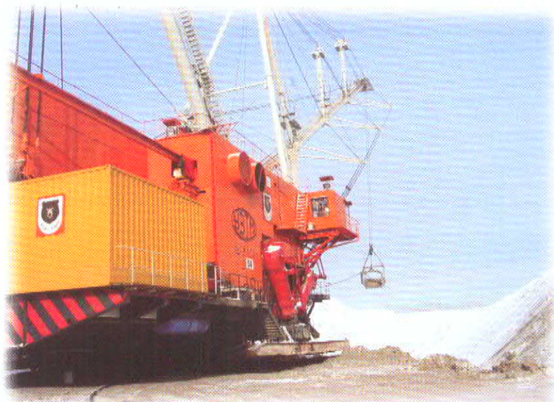
Эскаватор ЭШ 90/15 - ELHY® - толкатели работают в дисковых тормозах привода иодъёма
